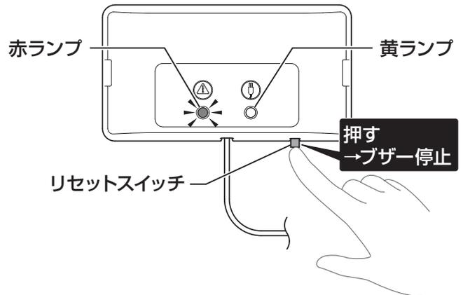
異常が解消し、本体のランプが緑に点灯に戻ったにもかかわらずアラームボックスの赤ランプが点灯している場合は、リセットスイッチを押すと消灯状態に戻ります。
