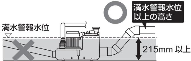
※管内が満水状態になり、漏水の原因になります。
